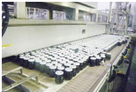
▲製品を加熱殺菌後、シャワーで冷却する装置です。
