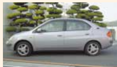
ガソリンエンジンと電気モーターを併用したハイブリッドカー
